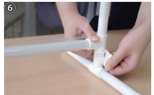
⑥最後に両サイドを下部のT型ジョイントの接合部にテープを巻き付け固定します
