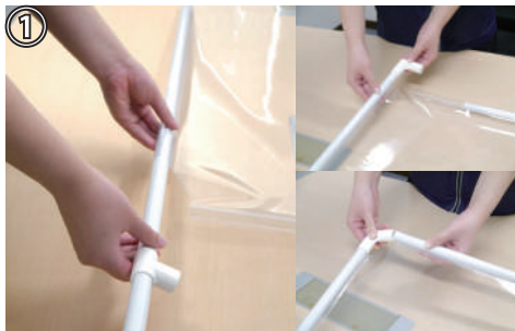
①時計回りの順にT型ジョイントとL型ジョイントをパーテーション袋にパイプを差し込みます
