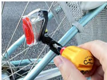
③ブラケットのネジを締め、固定します。
