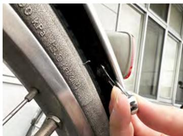
①ドロコケに取付けられているリフレクターを裏側のナットを緩めて取り外します。
