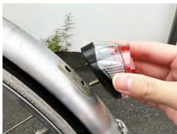
③本品をソーラーパネルが上になるようにはめ込み裏側から付属のナットで締め付けます。
