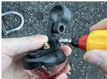
②リフレクター面が地面に対して垂直になるようにブラケットの角度を調整します。
